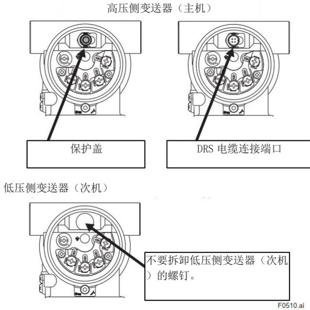
图 5.10 拆卸保护盖
