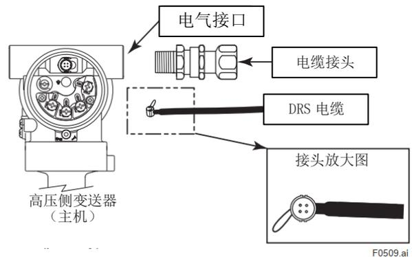
图 5.9 安装 DRS 电缆的电缆接头
