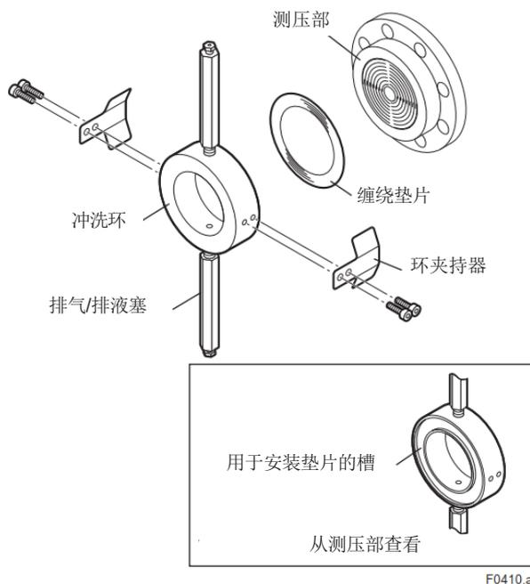
图 4.12 安装到测压部
