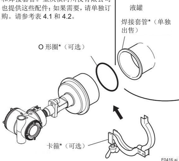
图 4.7 安装卫生型密封 (凸法兰)
