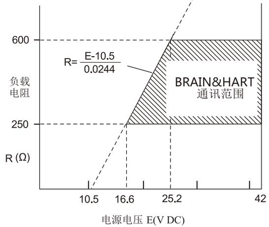
图2: 电源电压与外部负载关系图
