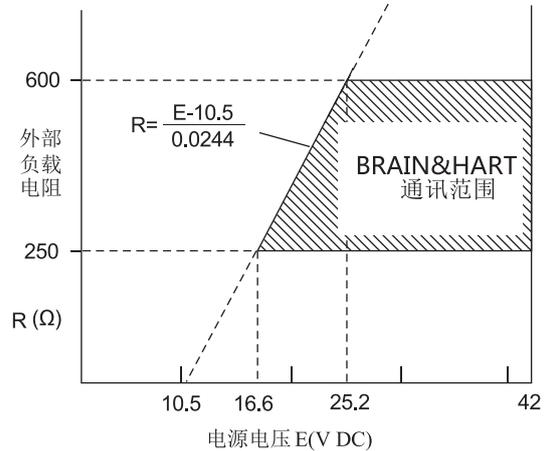
图2. 电源电压与外部负载关系图
