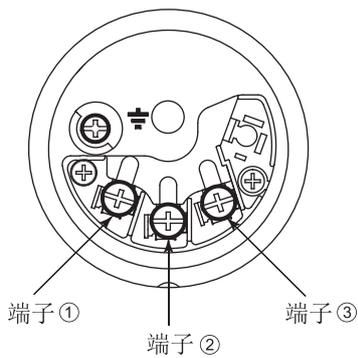
● 4 ~ 20mA输出、FF和PROFIBUS PA现场总线通讯接线端子
